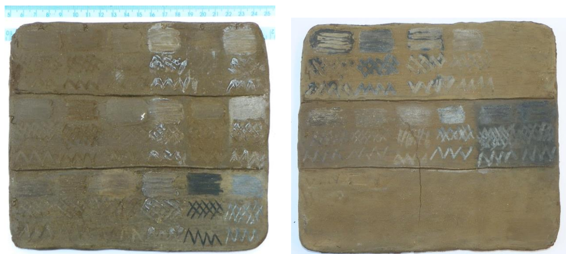
Fig. 118 – Placa de testes de brunimento executado com vários instrumentos em diferentes fases de secagem. Linha 1 na fase muito húmida; Linha 2 passadas poucas horas; Linha 3 na fase de meio-seco ou “couro” no dia seguinte. Linha 4, 6- seco e re-húmdecido com pano (a linha 6 só foi preenchida imediatamente antes da cozedura), Linha 5 – seco. Os instrumentos utilizados foram A – madeira polida; B – seixo rolado; C – couro; D – madeira e gordura animal; E – seixo rolado e gordura animal; F – couro e gordura animal. Na linha 3, E e F, testaram-se outras substâncias: 3 E – pau de carvão; 3 F – pau de grafite Na linha 4 e 5 testaram-se várias combinações com os mesmos materiais.
