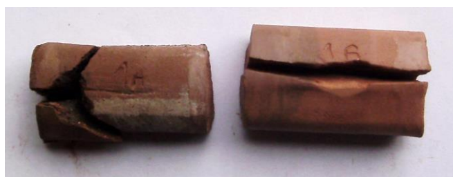
Fig. 126 – Cozedura oxidante a 600°C. Neste caso na extremidade esquerda aplicou-se gordura animal e tentou brunir-se com couro e extremidade direita aplicou-se a aguada com sal e também o couro. A gordura impediu o efeito brunido.
