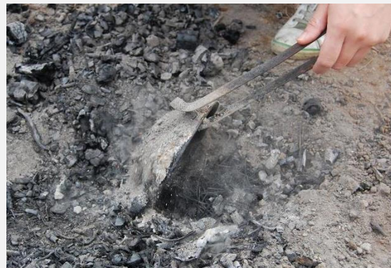
Fig. 128 – Principais fases da Experiência 1 – teste A de cozedura com atmosfera oxidante irregular e arrefecimento “abafado”.
