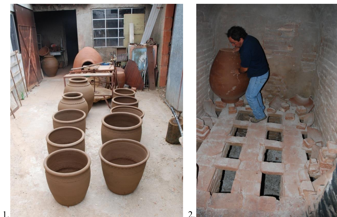
Fig. 109 – Oficina de António Mestre. 1. ordenação da carga no pátio antes da enfora. 2. António Mestre posiciona uma talha dentro da câmara de cozedura do forno.
