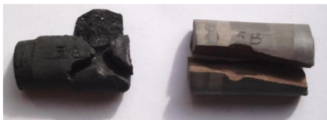
Fig. 125 – Detalhe das superfícies dos rolos. À esquerda, aplicou-se aguada com sal e bruniu-se um traço com madeira e, à direita, aplicou-se água simples e bruniu-se com couro.
